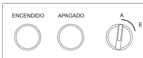
7) Para activar el Reloj Maestro gire nuevamente el interruptor de Encendido para llevarlo de la posición E a la posición A.
